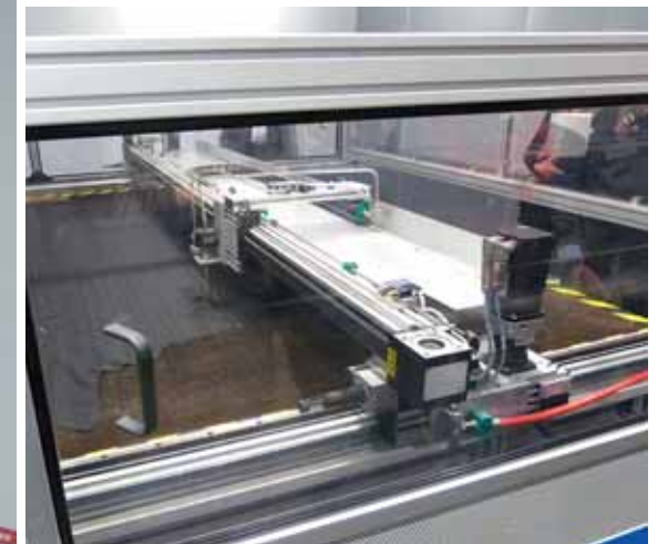
Die Schneidwerkzeuge bewegen sich simultan an zwei Portalen über die Lederhaut, ohne diese zu berühren
