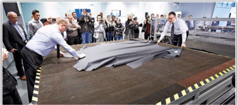
Praktische Vorführung des Lederzuschnitts mit Wasserstrahl.
