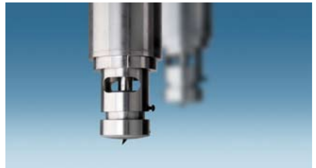
Oszillierendes Messer bis zu 20.000 Schwingungen / min
