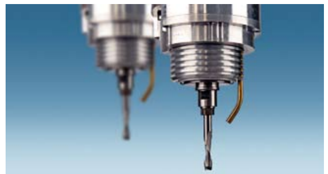
Fräskopf: Absauganlage inklusive
