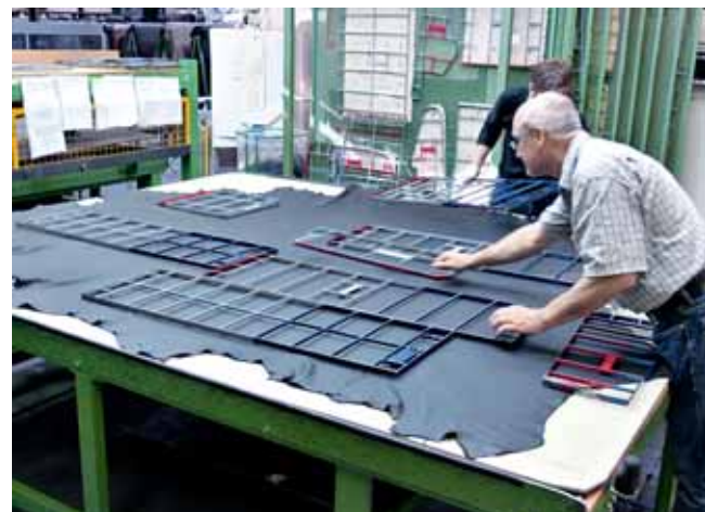
Oben: Die alte Rollenstanze, die hier von zwei Mitarbeitern mit Stanzformen belegt wird, ist bereits ausgemustert. Rechts: Lederkontrolle im Detail: Die Fehler werden mit dieser Lupe millimetergenau erfasst und in der Software hinterlegt
